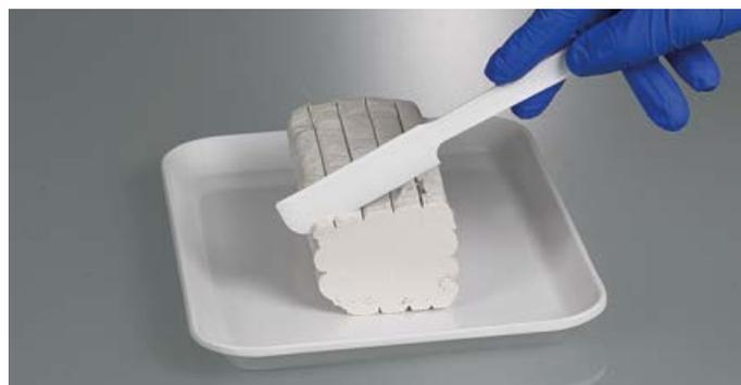
С помощью пробоотборного шпателя можно наносить, распределять или выглаживать такие густотекучие материалы, как пасты или кремы. Шпатель легко проникает в углы и закругления различных ёмкостей. Он предназначен для высребания чаш, для удаления остатков или для очистки мерных и дозирующих ложек Bürkle.
