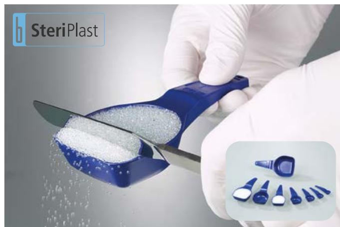
С помощью мерных и дозировочных ложек можно точно отмерять и дозировать небольшие объемы порошка, гранул и жидкостей. Для точной дозировки избыточный материал подбирается верхней кромкой ложки. Вместительность указана на ручке.
