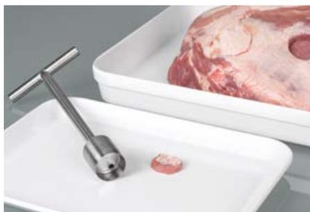
Пробоотборник для мяса «БифСтикер» (BeefSteaker) для ручного вырезания фрагмента ткани для микробиологического исследования поверхности туши животного. Буровая коронка вкручивается вручную.
