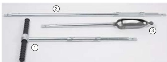
Чрезвычайно прочный прооботборник с закаленными коваными головками бура. Предназначен для определения свойств грунтов, их влажности и структуры. Форма головок бура «Крот» (Mole) обеспечивает минимальное сопротивление при введении и извлечении прооботборника. Это способствует снижению физической нагрузки при работе с ним.
