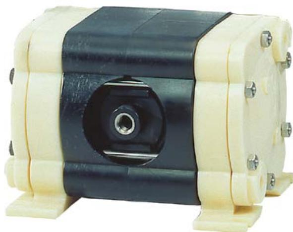
Насос с двойной диафрагмой работает на сжатом воздухе и предназначен для перекачки вязких, коррозионноактивных и абразивных жидкостей. В исполнении 1/4". Насосы изготовлены из полипропилена, ПВДФ или ПА. Диафрагмы, краны и седла клапанов изготовлены из термопластичных эластомеров геоласт и сантопрен, а также ПТФЭ. С помощью насоса можно перекачивать суспензии с диаметром частиц до 1,6 мм.
