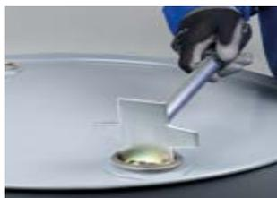
Универсальный гаечный ключ для бочек позволяет с легкостью открывать бочки с крышками от 3/4" до 2". Отличается высокой прочностью. Изготовлен из оцинкованной стали.
