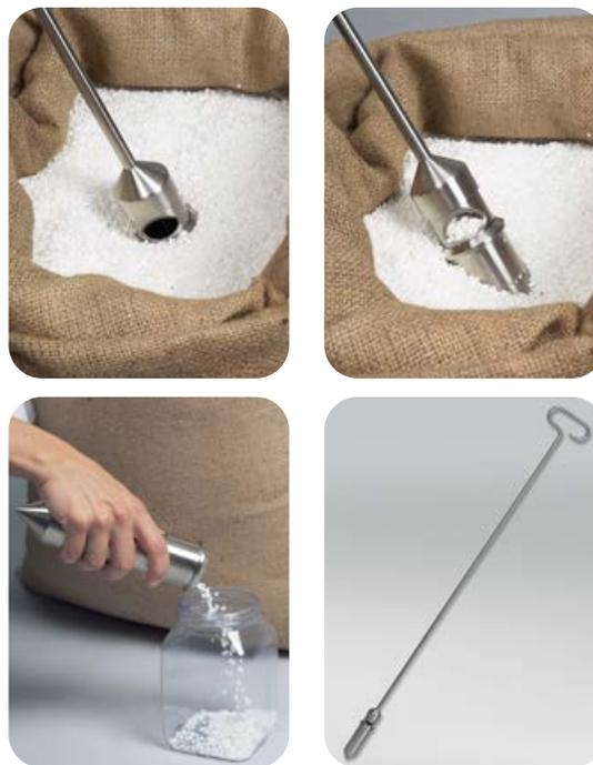
Пробоотборник „СилоПикер“ (SiloPicker) идеально подходит для отбора проб насыпных материалов из зернохранилищ. С помощью удлинительных штоков возможен отбор пробы с глубины до 350 см.
