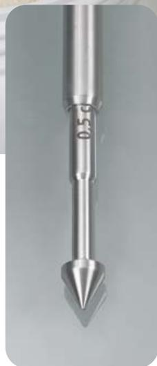
«МикроСамплер» (MicroSampler) предназначен специально для отбора микропроб порошкообразных материалов.
