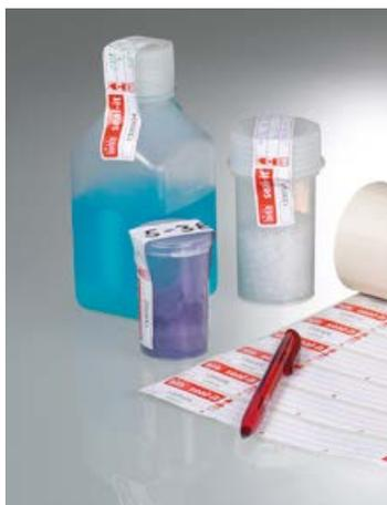
Как правило, образцы для сравнения сохраняют на случай необходимости их последующего использования в качестве образцов сравнения. Полная уверенность в том, что сохраненный образец для сравнения полностью идентичен исходному образцу, возможна только в случае, если соответствующая емкость была опломбирована и имела необходимую маркировку. В то же время, если на контейнере отсутствуют пломбировочные ушки, использование пломб становится невозможным.
