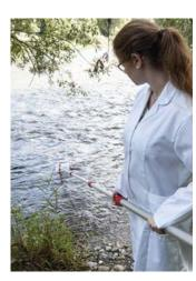
Универсальное приспособление для отбора проб "ТелеСкуп" (TeleScoop) с возможностью установки различных инструментов для решения широкого круга задач. Заменяемые устройства (наклонный стакан, маятниковый стакан, держатель для бутылей, стакан из нержавеющей стали) устанавливаются на телескопический шток с помощью удобного зажима-защелки.
