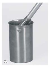
Стакан автоматически возвращается в горизонтальное положение. Проба не проливается. Может быть использован для отбора проб из узких и глубоких шахт (диаметр 130 мм).
