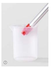
Стакан автоматически возвращается в горизонтальное положение. Проба не проливается. Может быть использован для отбора проб из узких и глубоких шахт (диаметр 150 мм).
