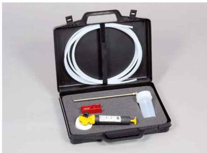
Специально предназначен для случаев, когда требуется обеспечение максимальной степени чистоты пробы. Пробоотборник «МиниСамплер» (MiniSampler), ПТФЭ, с аксессуарами в чехле для транспортировки. В комплекте: 1 вакуумный насос, 1 контейнер для проб (180 мл, ПФА), всасывающий шланг 6x8 мм (5 м, ПТФЭ), 1 нож для шлангов, 1 груз для шлангов (нержавеющая сталь V2A (1.4301)/никелированная латунь), 20 пломб «Сил-Ит» (seal-It).
