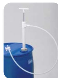
Части насоса, вступающие в непосредственный контакт с жидкостью, изготовлены из ПТФЭ и ФЭП. Эти материалы имеют очень высокую химическую устойчивость, и изделия из них можно использовать для работы с жидкостями, несовместимыми с полипропиленом и ПВХ (за исключением содержащих молекулярный фтор).
