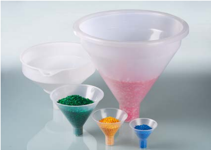
Воронки для работы с порошкообразными материалами. 9606-0240 с ситом из фосфористой бронзы (не рекомендуется использовать для пищевых продуктов).
